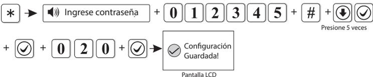
El tiempo de retardo de entrada puede ser configurado de 1 a 255, anteponga ceros cuando sea menor de 3 dígitos. Después que la configuración esté completa, la pantalla regresará automáticamente a la interfaz superior.
