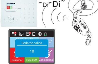
Presione la tecla de armado remotamente o en el teclado, entonces escuchará que el sistema se armó, salga del área protegida, escuchará 2 pitidos que confirmarán que el sistema se armó exitosamente.
