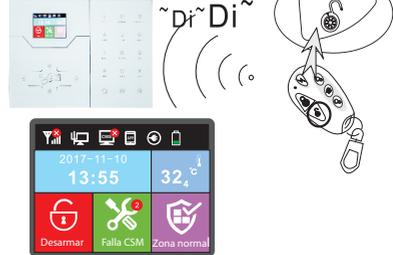
Presione la tecla desarmado remotamente o digite su contraseña de usuario en el teclado, escuchará dos pitidos y el sistema de voz dirá "Sistema desarmado", entonces el sistema habrá sido desarmado exitosamente.
