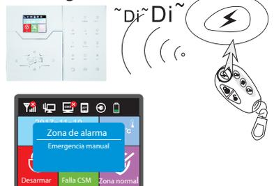
Presione el botón de pánico remotamente, o presione la tecla 3 en el panel por 3 segundos, esto disparará la alarma.
